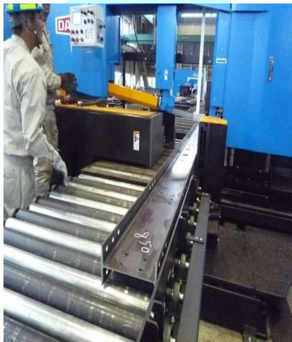
加工機にて 切断・穴あけ
